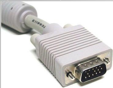
ПК достаточно давно использует 15-контактный интерфейс Mini-D-Sub для подключения монитора (HD15) и сегодня вытесняется интерфейсами DVI и HDMI.
