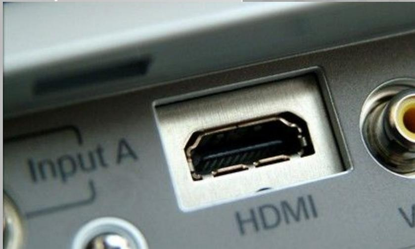
Текущая технология использует вилки типа А с 19 контактами.
