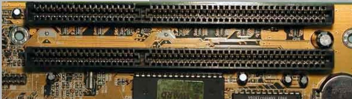
ДЛЯ ПЕРЕДАЧИ ДАННЫХ ПО ШИНЕ ТРЕБУЕТСЯ ОТ ДВУХ ДО ВОСЬМИ ТАКТОВ. ПОЭТОМУ МАКСИМАЛЬНАЯ СКОРОСТЬ ПЕРЕДАЧИ ДАННЫХ ПО ШИНЕ ISA СОСТАВЛЯЕТ 8,33 МБАЙТ/С.
