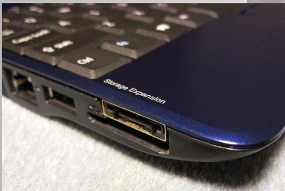
Может быть использован для горячего подключения жесткого диска (в BIOS необходим режим AHCI).
