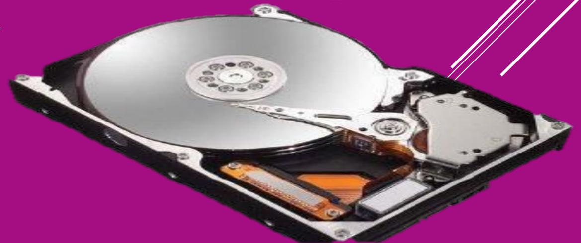
**IDE, или ATA.** Согласно этому интерфейсу жесткие диски подключаются к контроллеру с помощью 40- или 80-жильного шлейфа. К одному шлейфу можно подключить сразу два устройства, но для этого нужно верно выставить переключки на накопителе и проверить параметры этого накопителя в BIOS.
