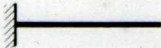
Неподвижное закрепление оси,
