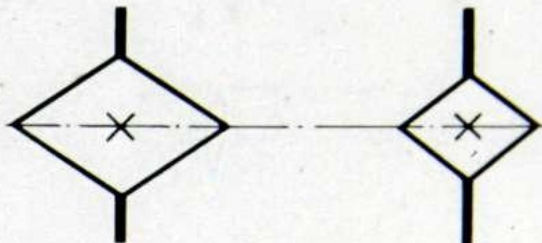
Передача цепью (общее обозначение без уточнения типа цепи)
