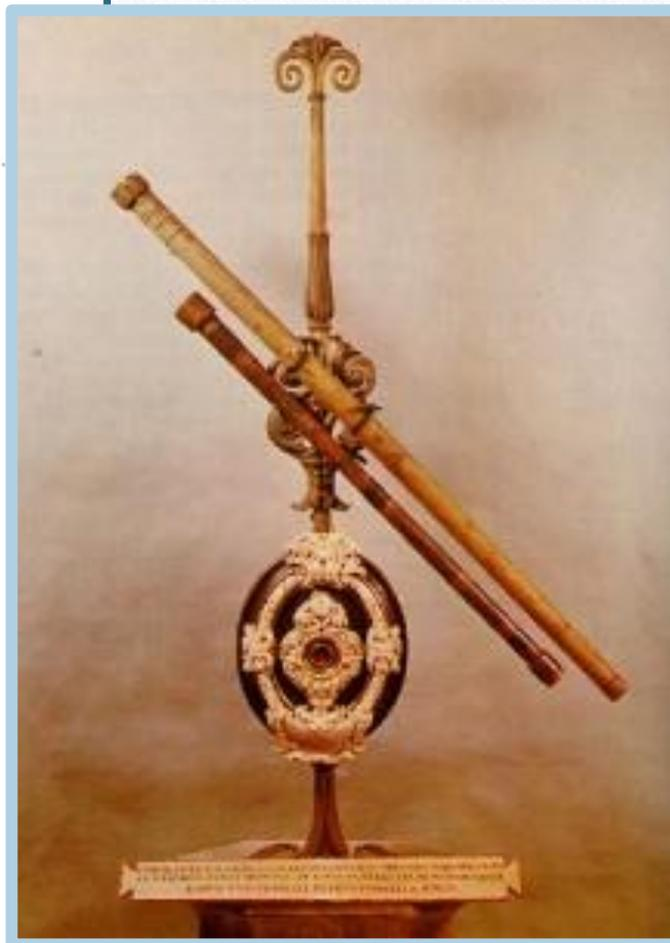
Рис. 5. Первые зрительные трубы Галилея. В центре фигурной подставки, поддерживающей трубы, расположен разбитый объектив третьей трубы, изготовленной Галилеем в 1609 г.
