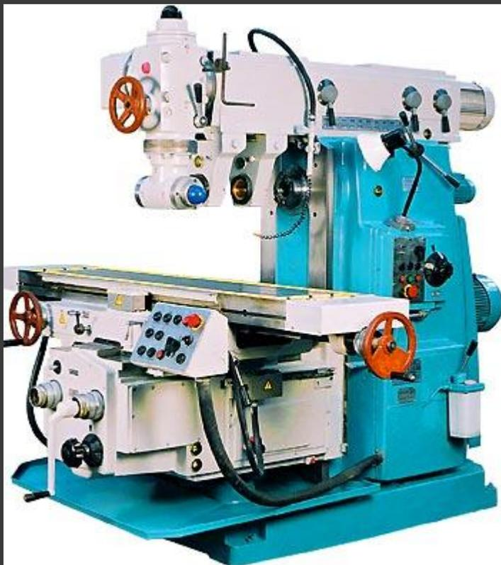
Широкоуниверсальный фрезерный станок 6Т82Ш (6Р82Ш) предназначен для выполнения разнообразных фрезерных, сверлильных и расточных работ цилиндрическими, торцевыми, концевыми, фасонными и другими фрезами. Применяются для обработки горизонтальных и вертикальных плоскостей, пазов, рамок, углов, зубчатых колес, спиралей, моделей штампов, пресс-форм и других деталей из стали, чугуна, цветных металлов, их сплавов и других материалов.
