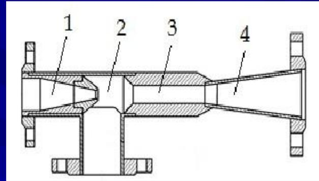
Благодаря разности гидростатических давлений на выходе из элеватора и в обратном трубопроводе создается циркуляционный напор.
