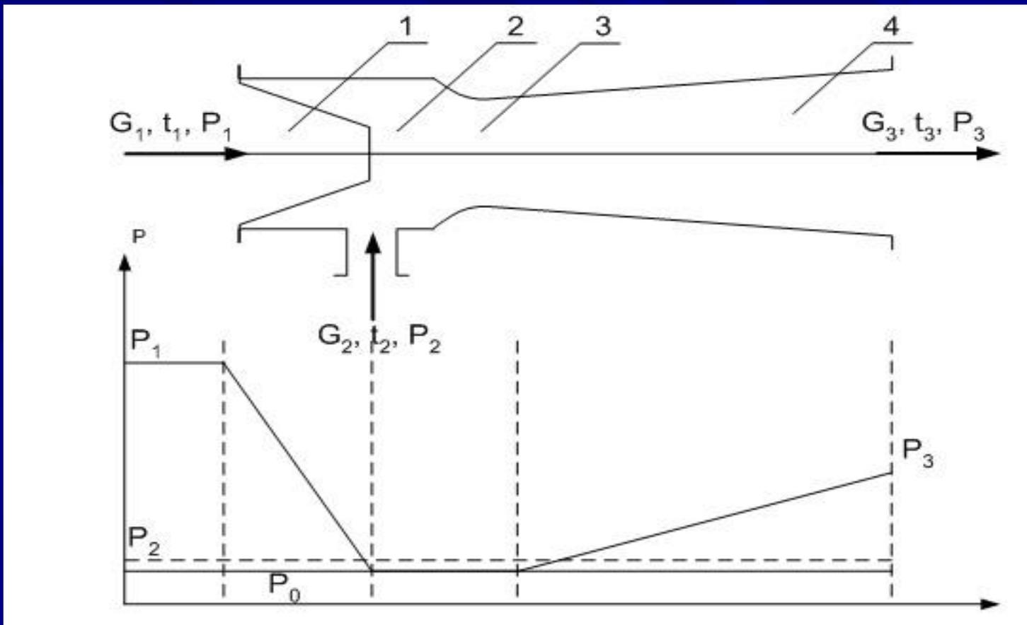
Основной характеристикой элеватора является коэффициент смешения (инжекции) – отношение количества инжектируемой воды  $G_2$  к количеству воды, поступающей из тепловой сети  $G_1$ :
