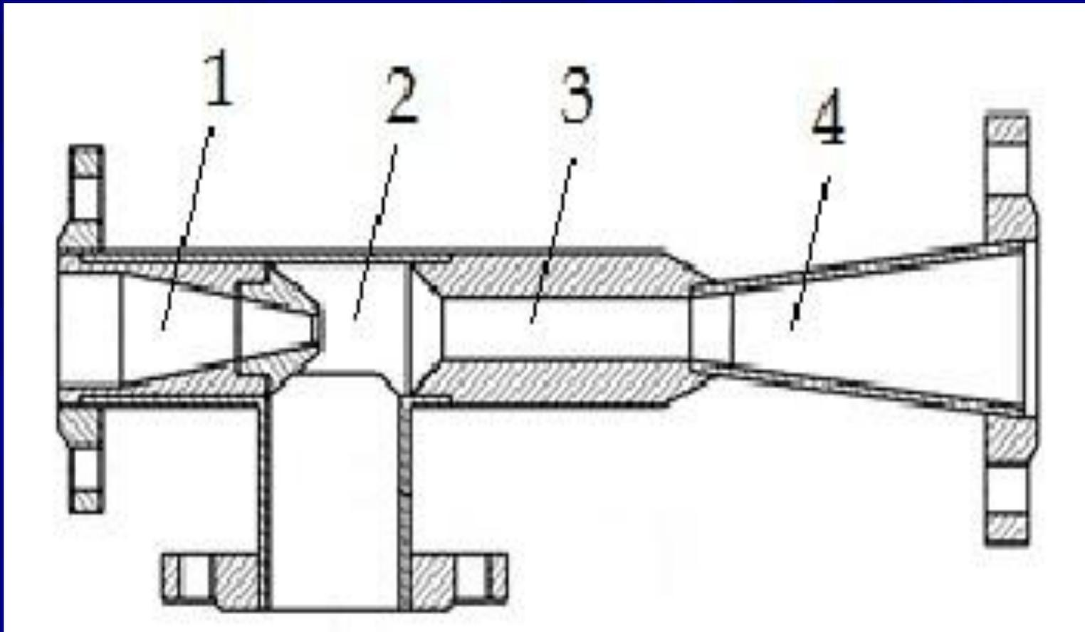
Элеатор состоит из сопла -1, камеры всасывания -2, камеры смешения -3 и диффузора -4.
