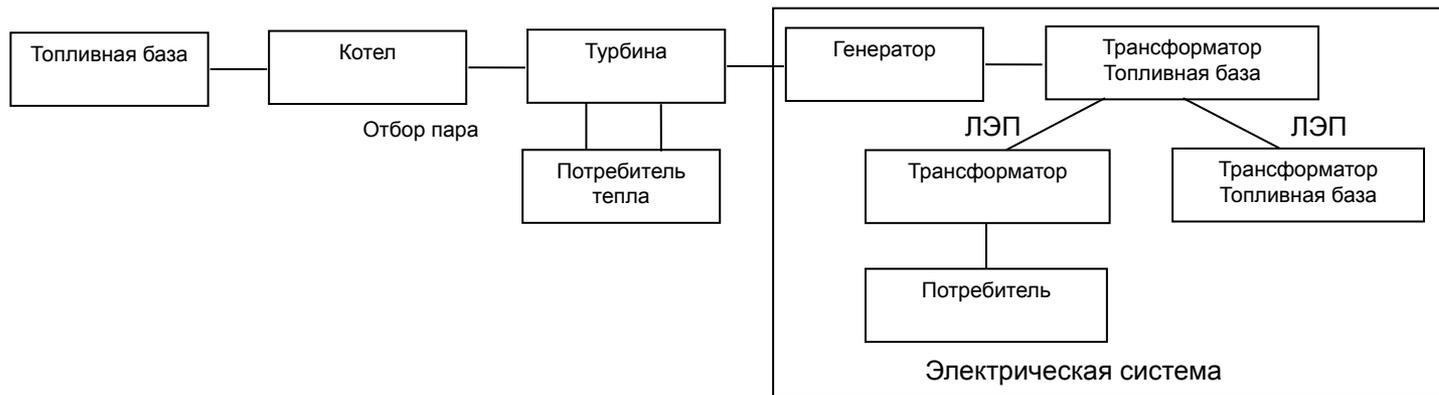
Технологическая схема производства и распределения электроэнергии
