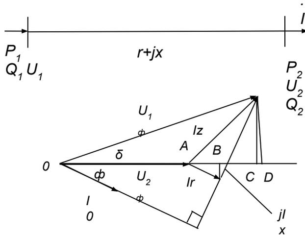
ВД для определения потери напряжения в линиях электропередачи
