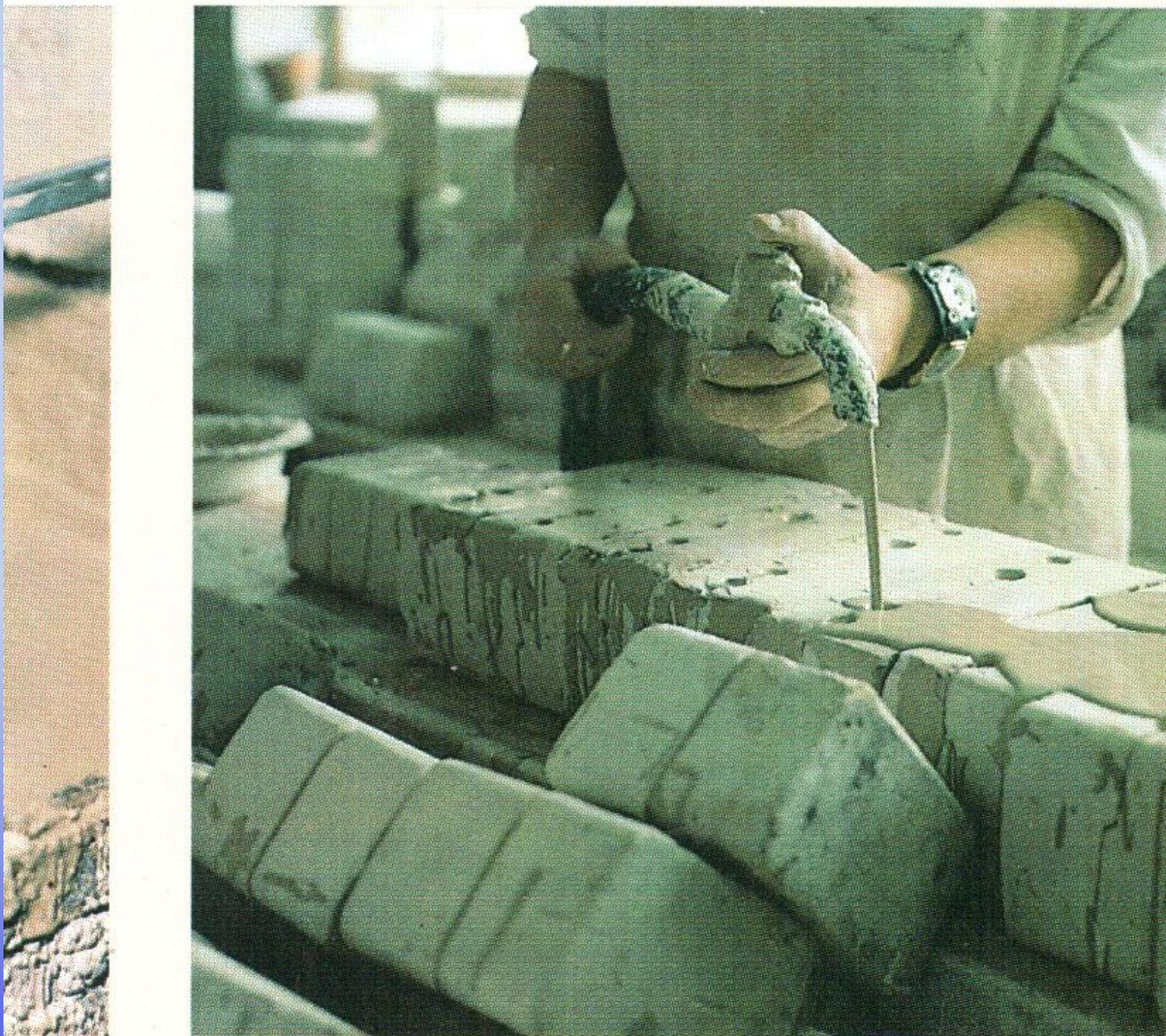
*Шликер (фарфоровая масса, разбавленная водой до консистенции жидких сливок) подается в цех по трубам, от которых отходят резиновые шланги, заканчивающиеся пистолетом-дозатором.*
