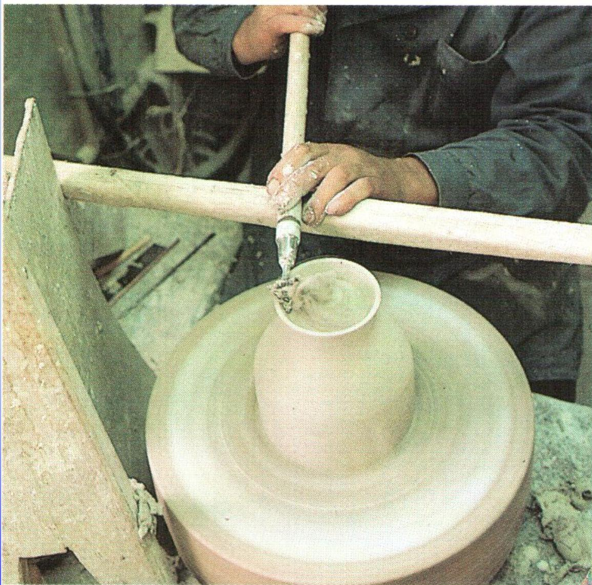
Станок для вытачивания модели представляет собой гончарный круг, снабженный двумя стойками. На них укладывают деревянную рейку (правилку), служащую для упора рук и клюшки (стального резца в виде пластинки разной формы с длинной деревянной ручкой). Быстро вращается станок. Точными движениями резца мастер обрабатывает гипсовую заготовку, снимает излишек гипса, и модель постепенно приобретает нужную форму. Затем выточенную модель передают для формовки будущих изделий
