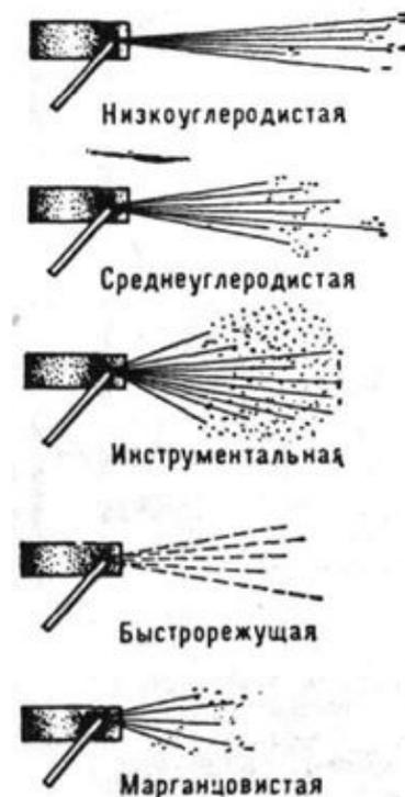
*Приблизённое определение химического состава стали по искровой пробе*
