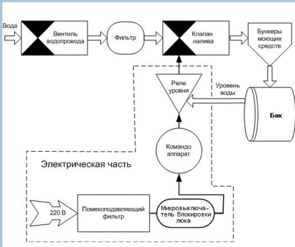
Включается двигатель. При помощи таходатчика регулируется скорость вращения барабана. По мере всасывания моющей жидкости происходит донабор воды в бак. Количество объема будет определяться заданной программой. Далее "мозг" платы включает тэн. Датчиком температуры регулируется нагрев. Время стирки будет зависеть от заданной программы.
