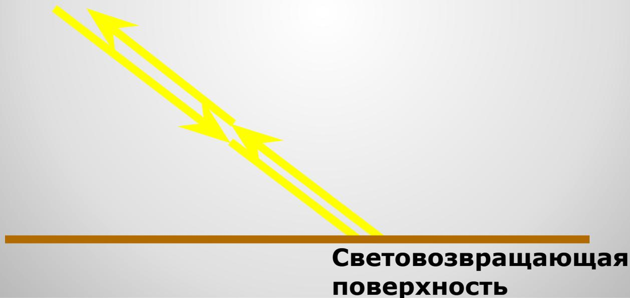
Световозвращатель — это пассивное устройство обеспечения безопасности
