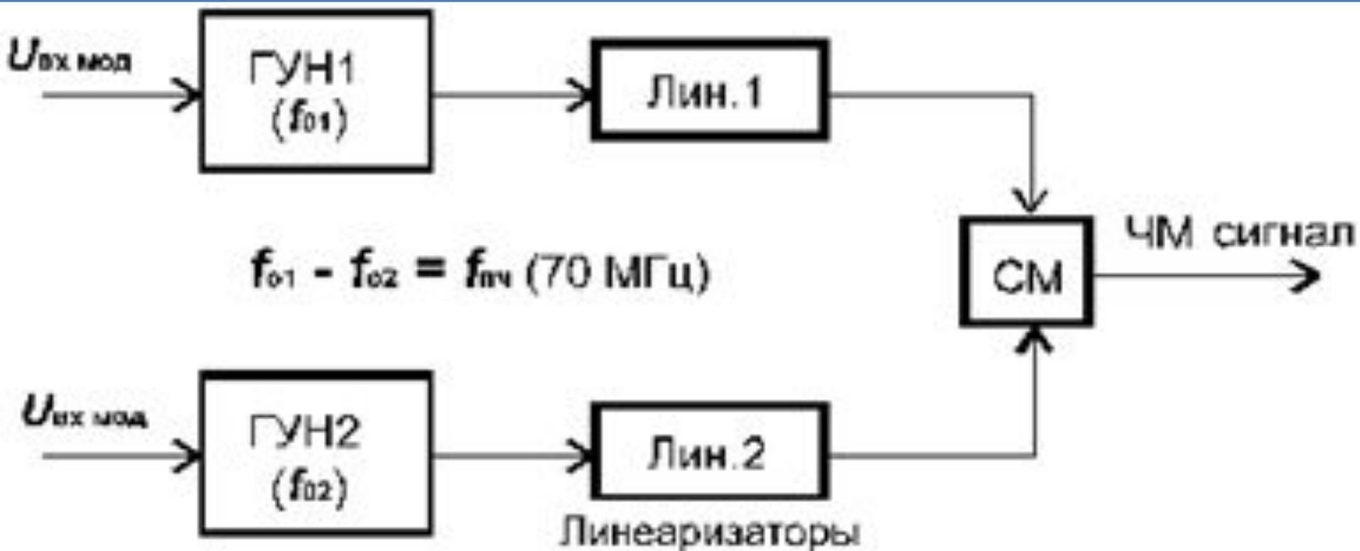
применяются два генератора, управляемых  $U$ , работающих на  $F=300-400 \text{ МГц}$ .  $F_{ген.}$  отличаются на величину  $F_{пр.}=70 \text{ МГц}$ , и выбираются так, чтобы продукты преобразования  $F$  в смесителе (СМ) не создавали помех в полосе частот 50-90 МГц.
