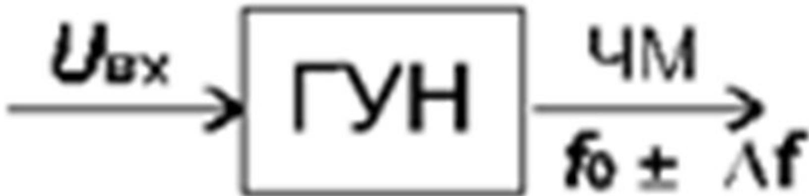
**Наиболее распространенный способ частотной модуляции заключается в воздействии на реактивные элементы колебательного контура, задающего частоту колебаний самовозбуждающегося LC генератора. Удобным современным элементом, применяющимся для этих целей, является варикап (варактор)**
