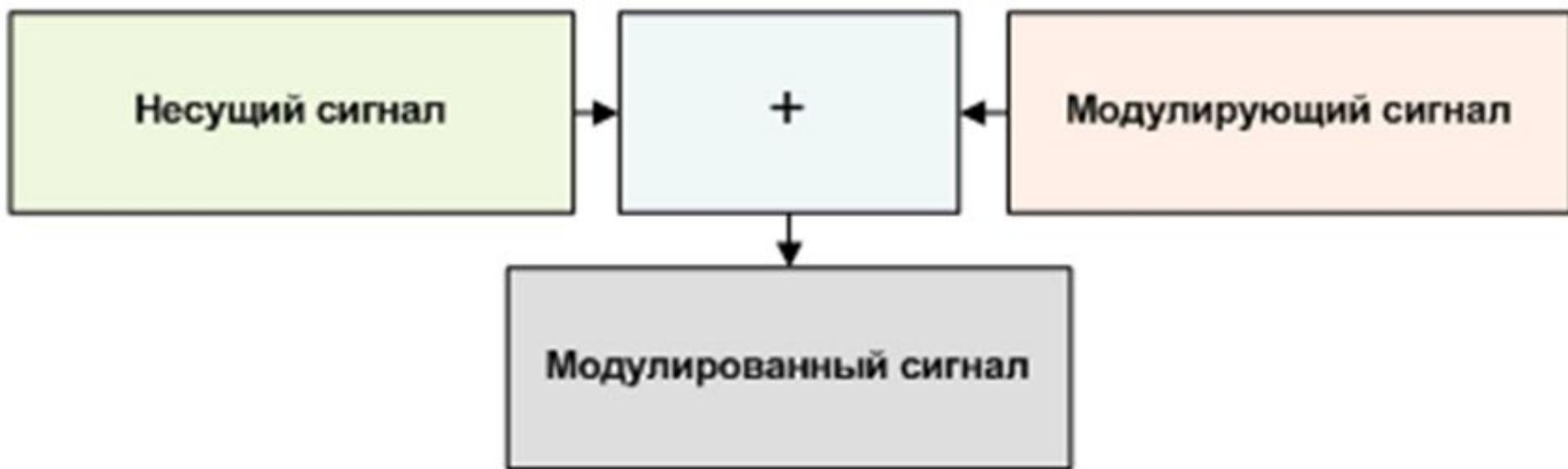
Передаваемая информация заложена в управляющем (модулирующем) сигнале. Роль переносчика информации выполняет ВЧ колебание, называемое несущим.
