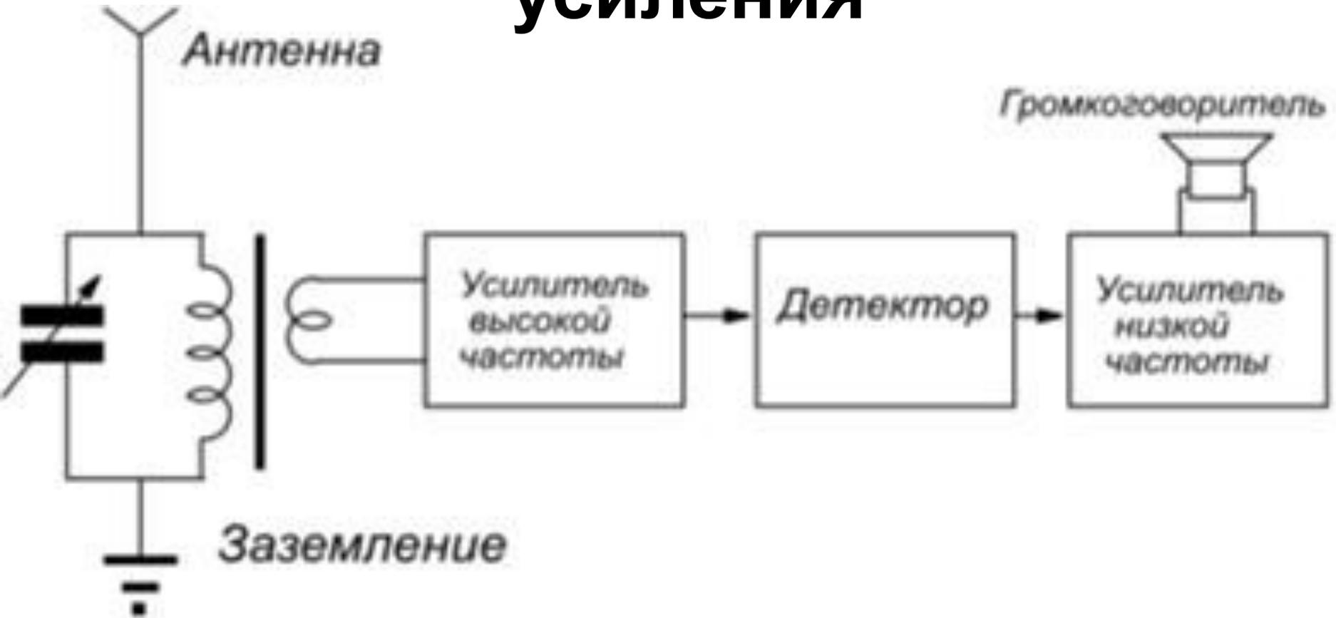
**герадеаус** состоит из колебательного контура, нескольких каскадов усиления высокой частоты, квадратичного амплитудного детектора, а также
