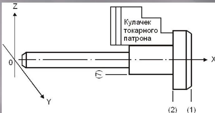
Эскиз установки заготовки в самоцентрирующем трехкулачковом патроне.
