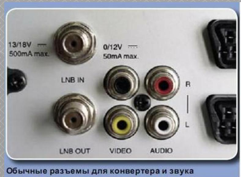
Обычные разъемы для конвертера и звука
