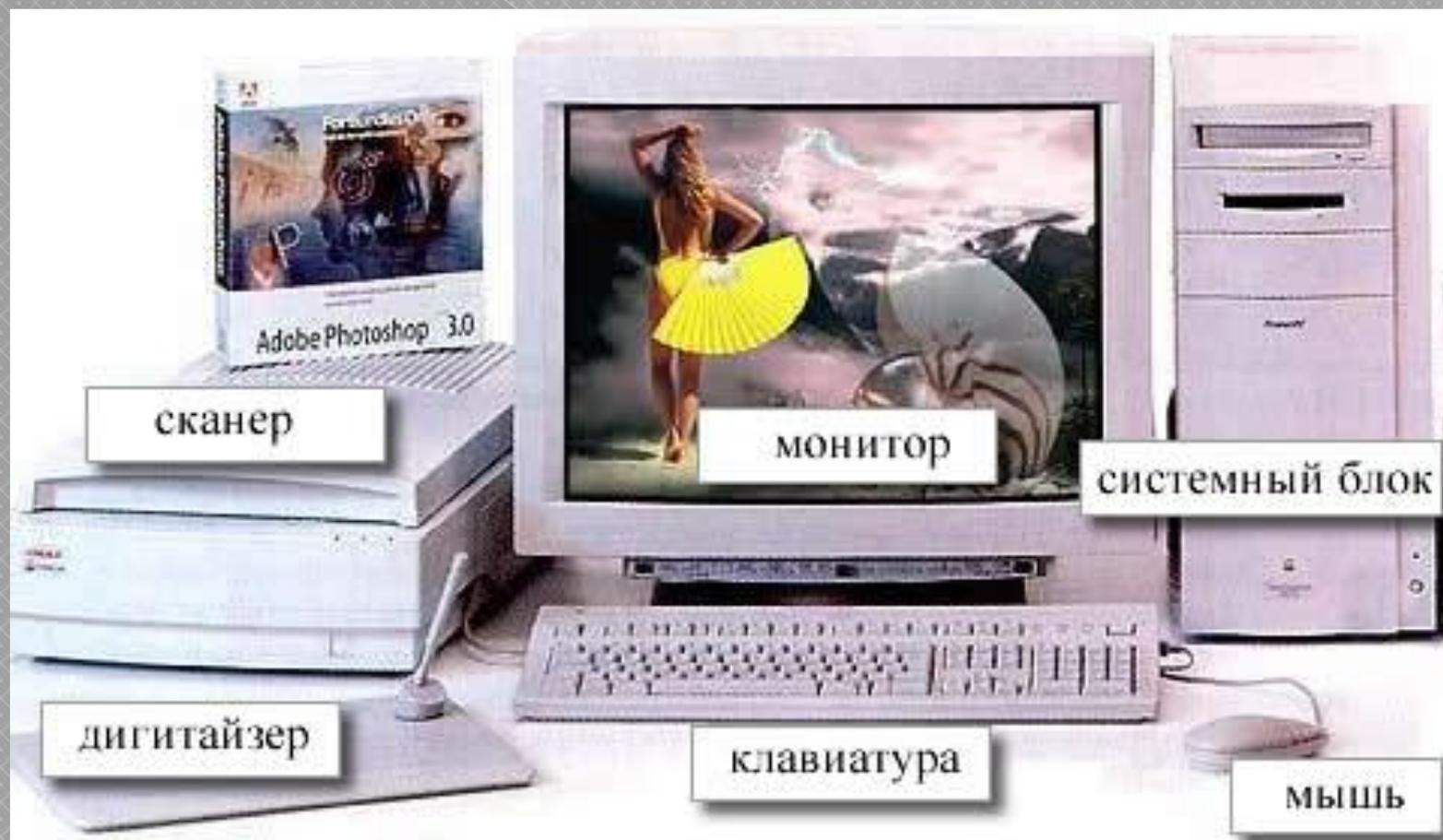
**Персональный компьютер** - универсальная техническая система, конфигурацию которой можно изменять по мере необходимости. Тем ни менее существует понятие базовой конфигурации. В настоящее время базовая конфигурация состоит из 4 составляющих:
