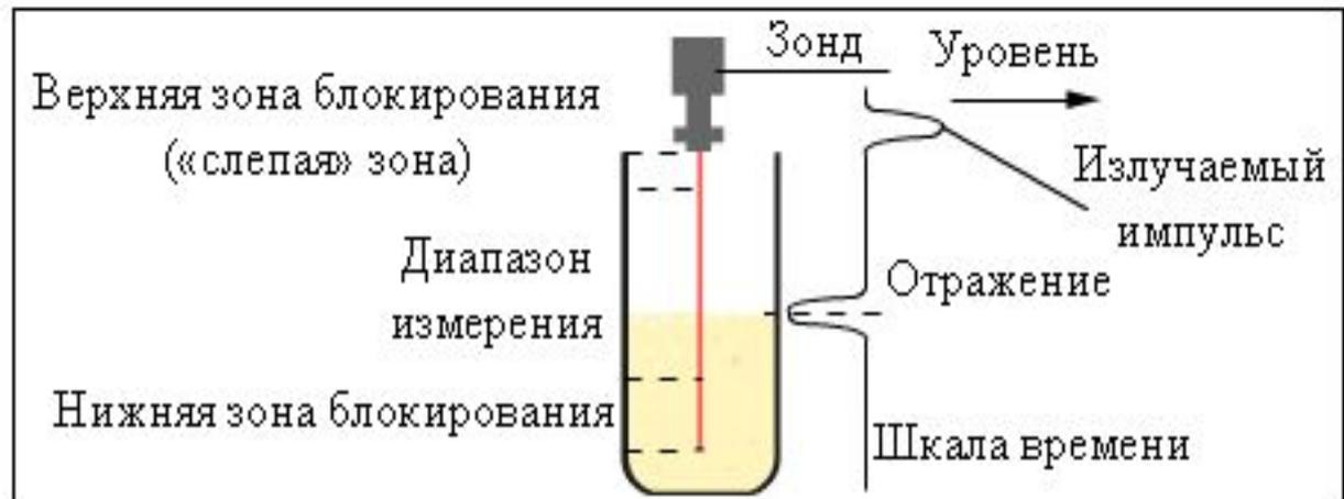
Датчик направленного электромагнитного излучения
