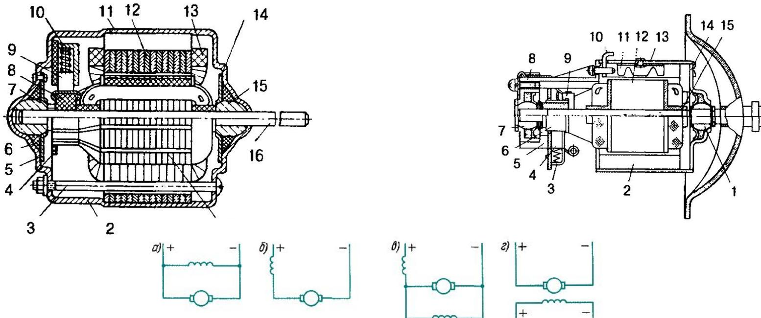
Рис. 12. Схемы, поясняющие способы возбуждения двигателей постоянного тока
