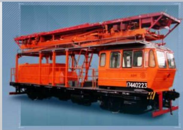
Предназначена для выполнения ремонтных работ контактной сети, а также производит полный монтаж контактной сети электрифицируемых участков :
