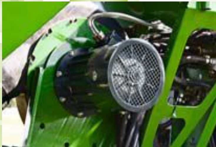
Detailed view 400 V fertiliser blower fan
