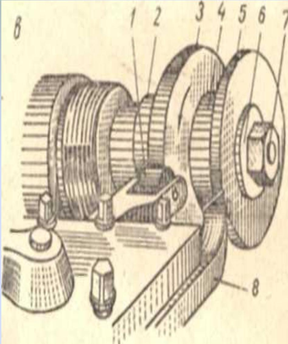
Устанавливается копир, заготовка и шайба в резцедержатель. В резцедержателе закрепляется ролик и резец. Ролик прижимается к копиру, установленному в суппорте вместо винта поперечной подачи. При включении продольного перемещения суппорта резец будет обтачивать деталь по профилю копира.
