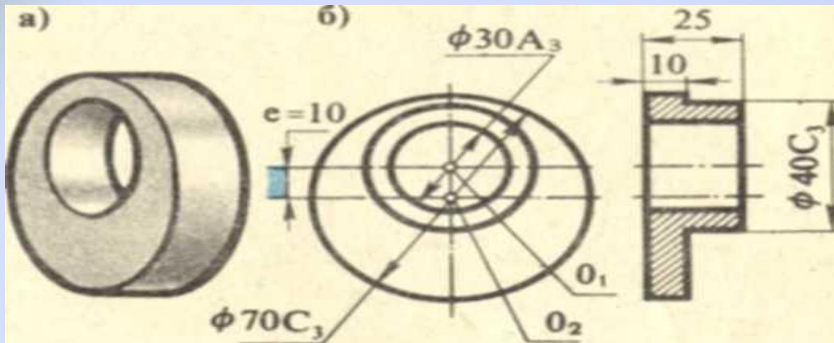
**ЭКСЦЕНТРИКОВЫМИ** НАЗЫВАЮТСЯ ДЕТАЛИ, У КОТОРЫХ ОСИ ОТДЕЛЬНЫХ ПОВЕРХНОСТЕЙ СМЕЩЕНЫ ПАРАЛЛЕЛЬНО ОСЯМ ДРУГИХ ПОВЕРХНОСТЕЙ. К ТАКИМ ДЕТАЛЯМ ОТНОСЯТСЯ ЭКСЦЕНТРИКОВЫЕ КУЛАЧКИ (ОСЬ ОТВЕРСТИЯ НЕ СОВПАДАЕТ С ОСЬЮ ДИСКА)
