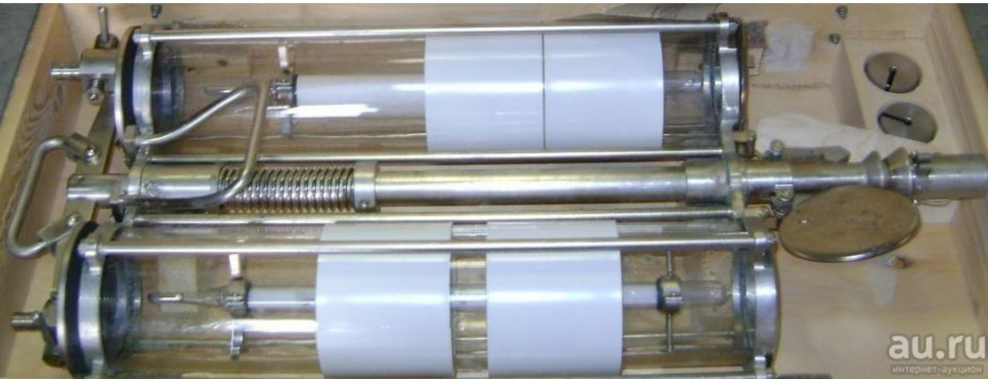
Батометр Молчанова ГР-1 8 предназначен для взятия проб воды с различных глубин водоемов, с одновременным измерением температуры воды исследуемого слоя, при температуре окружающей среды от плюс 1°С до плюс 40°С.
