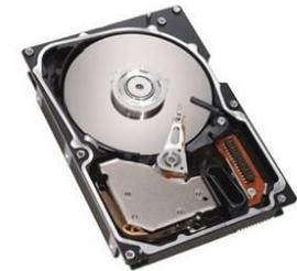
**Винчестер**- жёсткий диск, в компьютерном сленге напоминающее устройство хранения информации произвольного доступа, основанное на принципе магнитной записи. Является основным накопителем данных в большинстве компьютеров.
