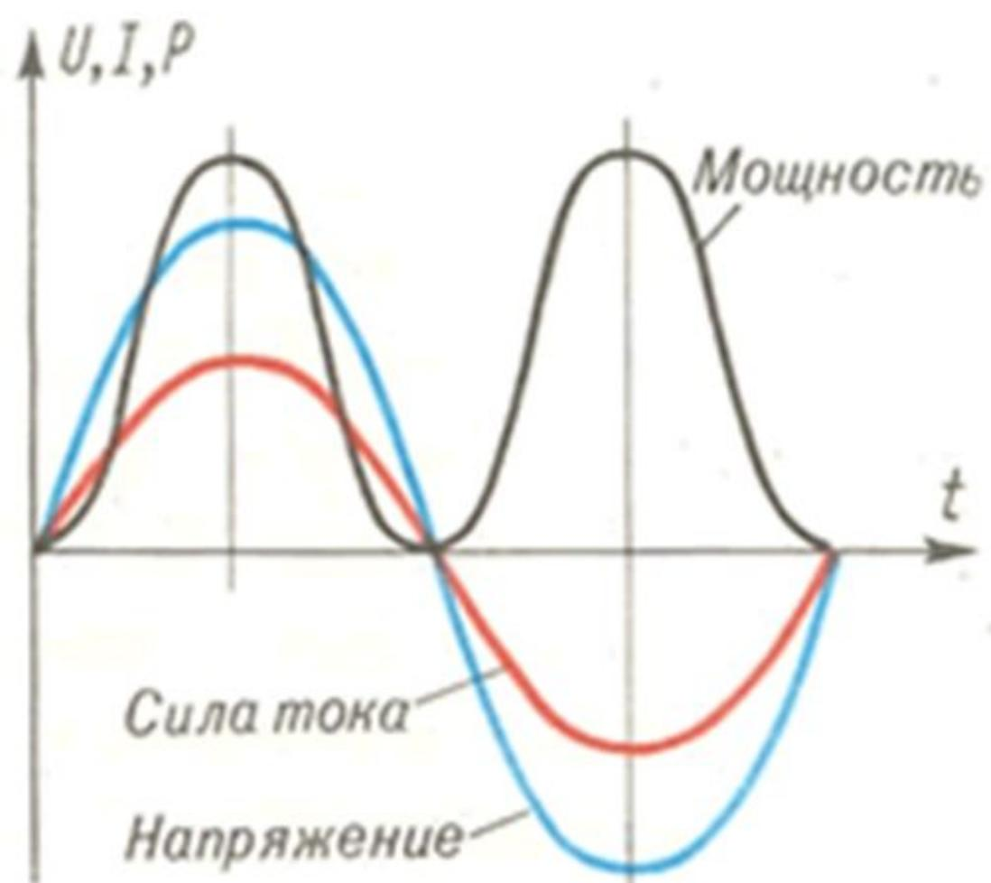
Кривая мощности при нулевом сдвиге фаз
