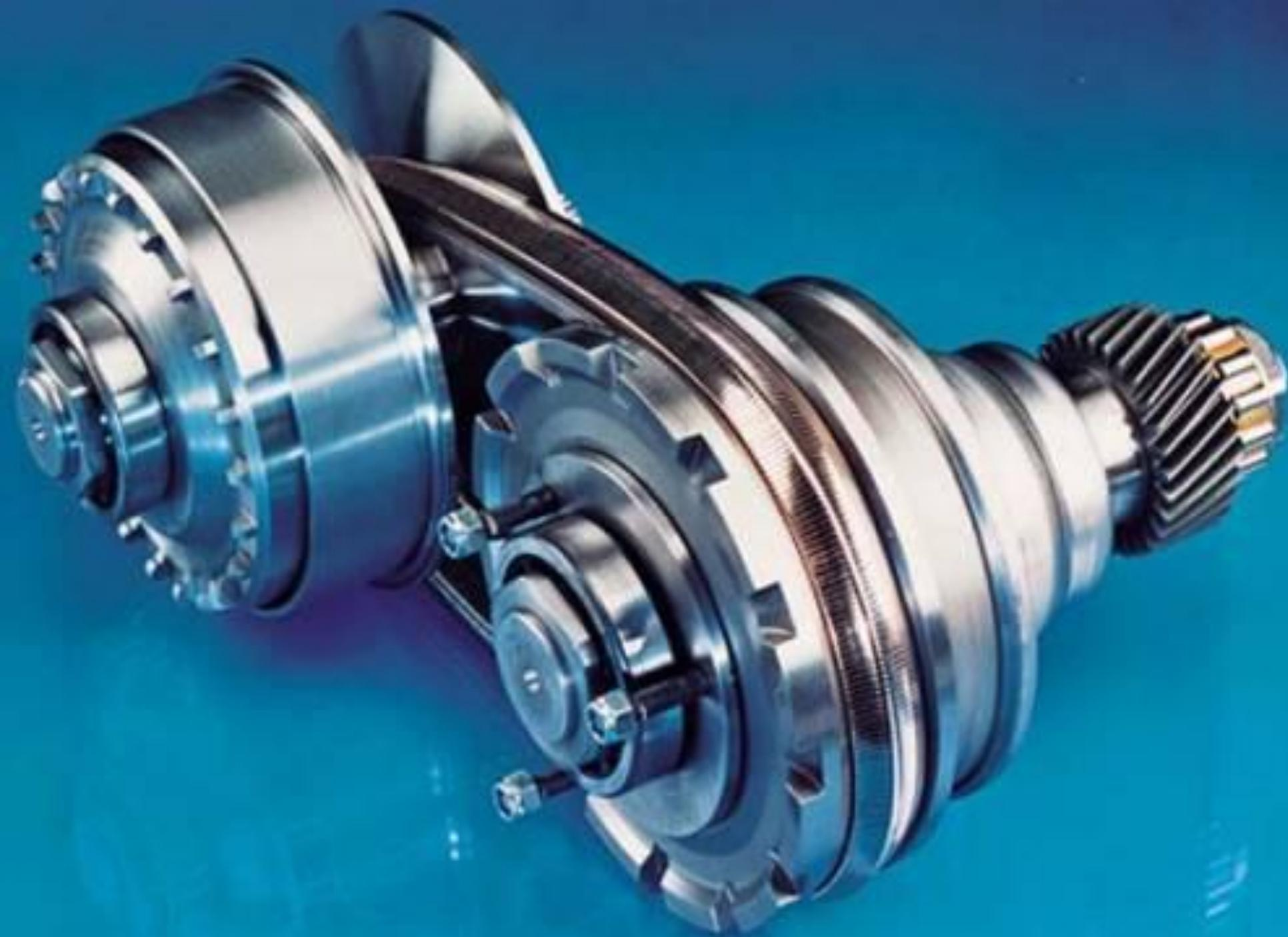
**Вариатор** (обиходное название – **вариаторная коробка передач**) является **бесступенчатой коробкой передач**, т.е. обеспечивает в заданном диапазоне плавное изменение передаточного числа.
