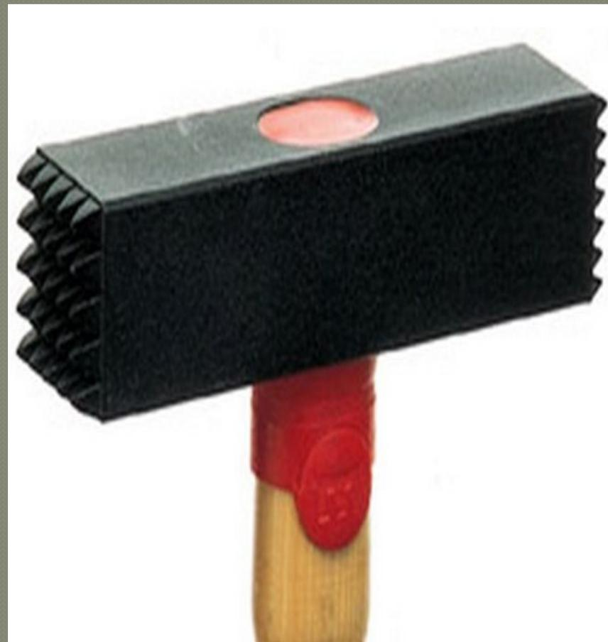
Бучарда – специальный молоток весом 1-1,5 кг, применяемый для насечки поверхностей подлежащих оштукатуриванию. Боевые части бучарды имеют насечки из нескольких рядов зубьев пирамидальной формы. Изготавливают бучарды из прочной инструментальной стали.
