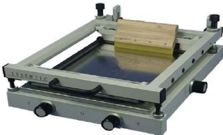
Печатная плата устанавливается на поверхности посредством двух направляющих брусков.
