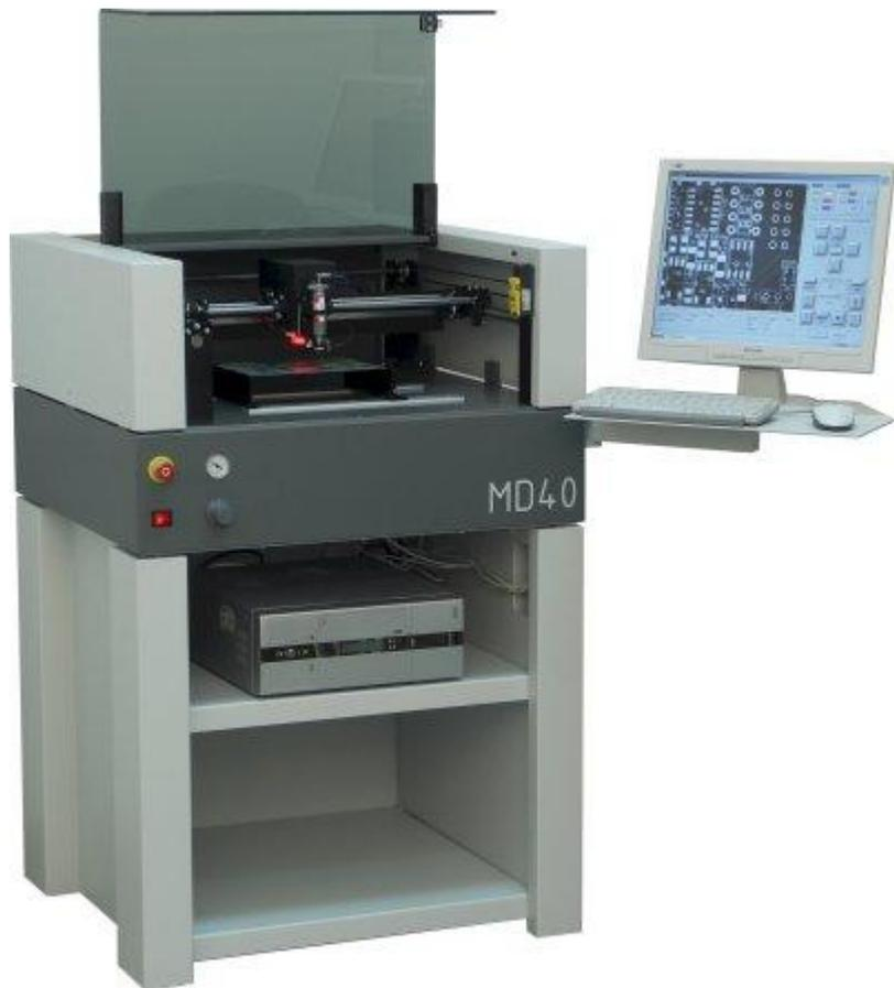
Система предназначена для нанесения паяльной пасты на печатную плату в виде отдельных точек в соответствии с заранее заданной программой.
