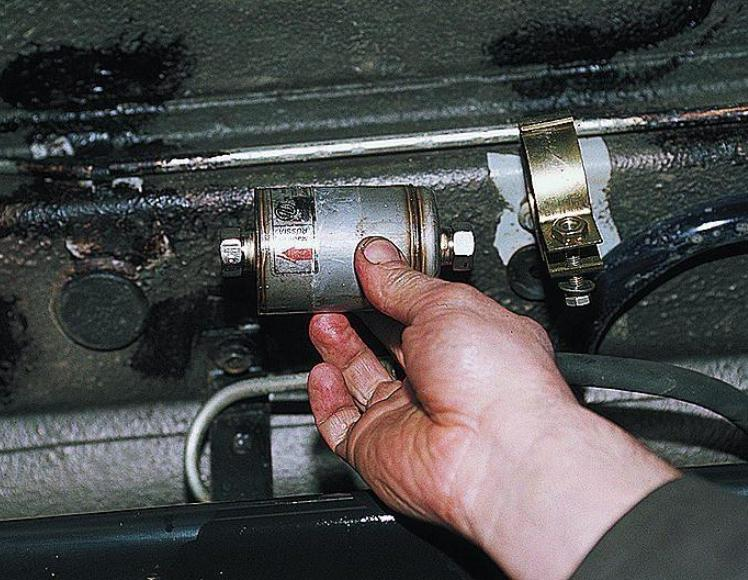
При промывке форсунок рекомендуется менять топливный фильтр в обязательном порядке, так как его состояние зачастую способно свести на нет всю работу с инжекторами.
