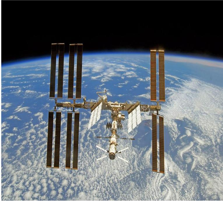
Монтаж станции непосредственно на орбите из секций и блоков, доставляемых с Земли, позволит получить конструкцию, наиболее приспособленную к орбитальным условиям. Конструкция станции в целом не будет рассчитана на значительные аэродинамические, инерционные и тепловые нагрузки, сопутствующие взлету и полету на активном участке траектории.
