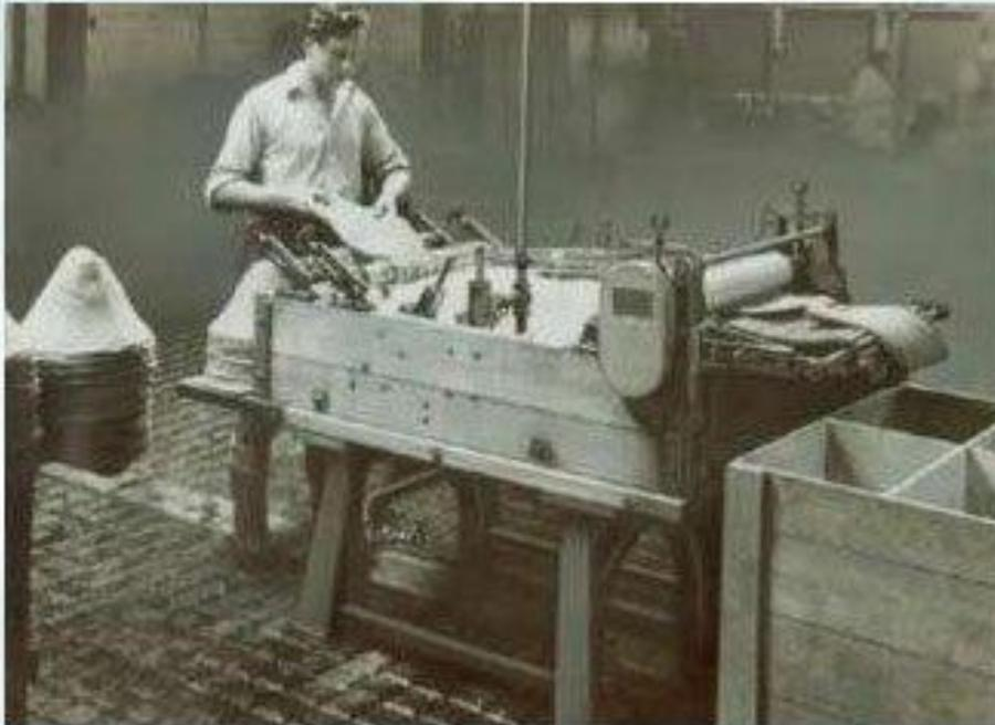
**В середине 19, начале 20 веков изобрели валяльные прессы, и валяльные машины. Валка происходила посредством сдавливания и прокатывания шерсти или при механическом воздействии специальных иголок, которые спутывали шерстяные волокна.**
