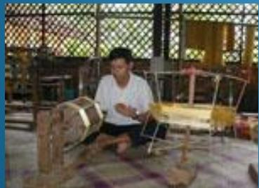
Чтобы размягчить кокон, его бросают в горячую воду, затем промывают и разматывают на специальных машинах.
