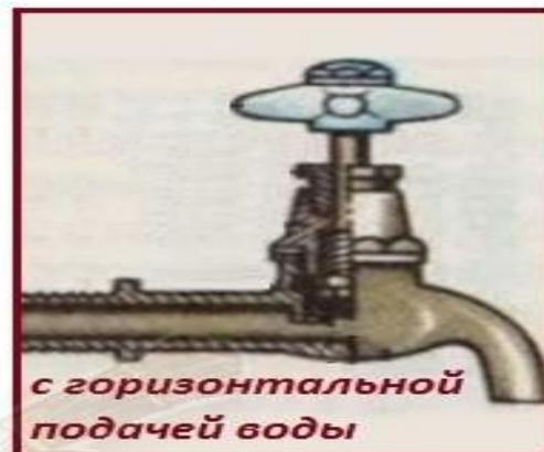
Вентильные краны - самая востребованная водопроводная арматура в благоустройстве загородной собственности. Привлекают вентильные устройства доступной ценой, простой конструкцией, износостойкостью деталей и возможностью самостоятельно отремонтировать.
