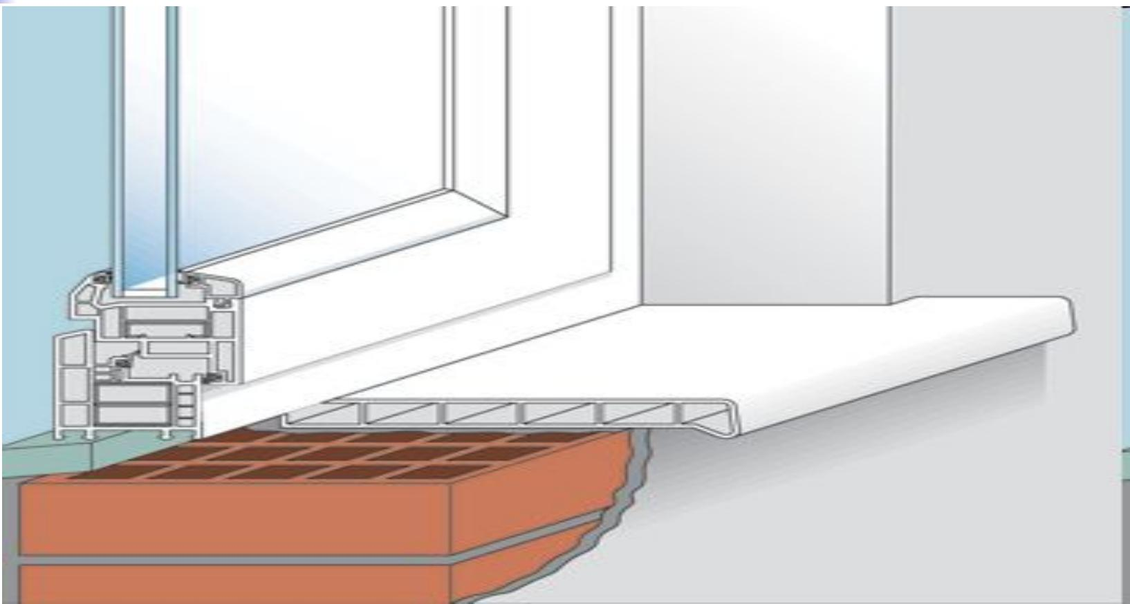
**Під вікном у нас є спеціальний профіль, званий - віконна пластина. Вона втоплена за рівень профілю вікна. Підвіконня вставляється впритул до цієї пластини, під профіль вікна.**
