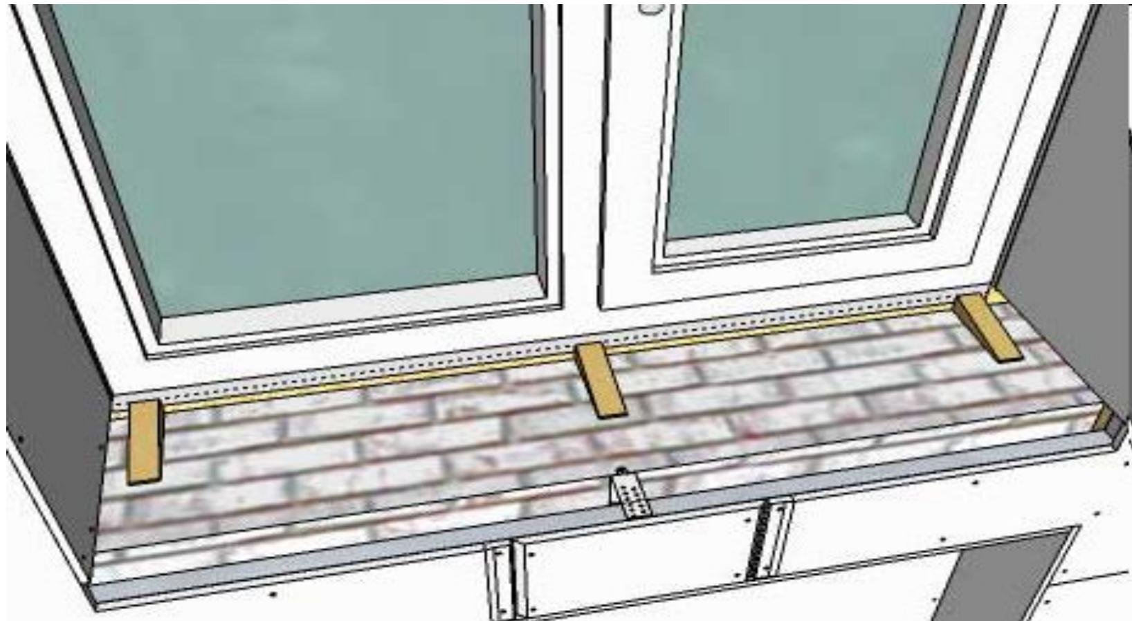
**На внутрішню сторону укосу, на профіль можна нанести клей, рідкі цвяхи, або силікон. На віконну пластину - силікон. Наносимо щільно, не шкодуючи. Зайвий якщо видавиться, приберемо потім, важлива герметизація, особливо під вікном.**
