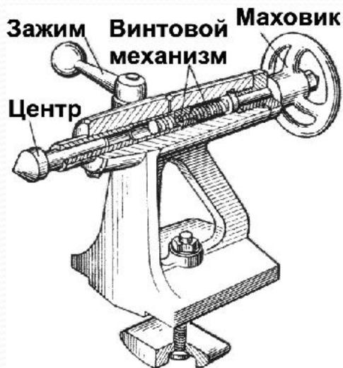
Задняя бабка (см.рис.) служит опорой правого конца длинных заготовок. Заднюю бабку подводят к заготовке по направляющим станины и закрепляют неподвижно болтом и гайкой. Окончательно конец заготовки поджимают специальной деталью — центром. Его перемещают вращением маховика и закрепляют зажимом.
