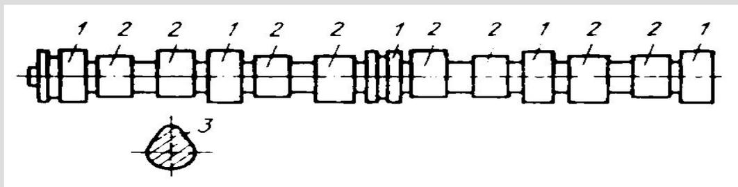
Схема распределительного вала четырехцилиндрового двигателя:
