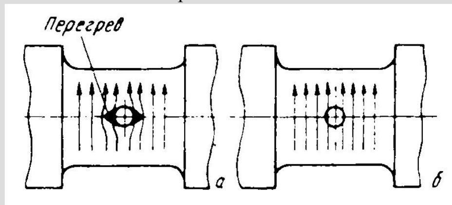
Схема распределения тока в шейке коленчатого вала:
