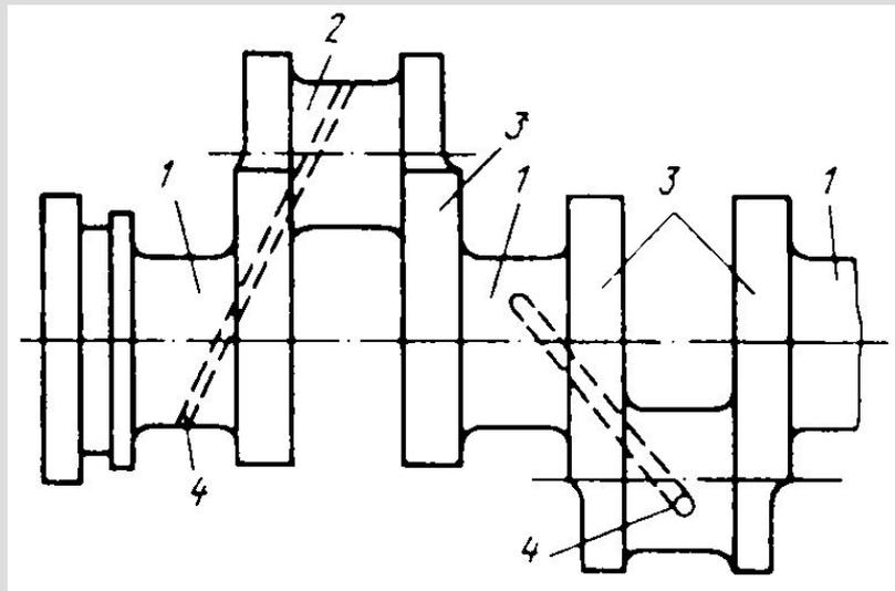
Схема элемента коленчатого вала многоцилиндрового двигателя:
