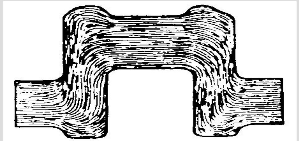
Схема макроструктуры штампованной заготовки коленчатого вала
