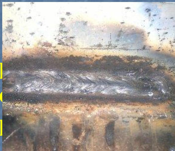
Сварной шов при правильном подборе технологии сварки выглядит ровно, симметрично, равномерно распределенным по поверхности основного металла .
