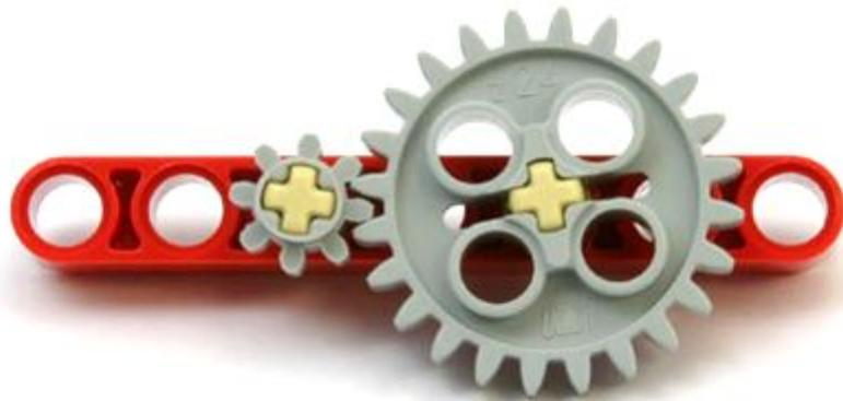
Повышающая зубчатая передача :
