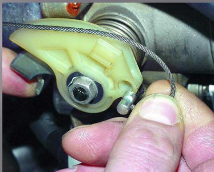
7. Отверните два болта крепления кронштейна тяги привода дроссельной заслонки. Отведите кронштейн в сторону, не отсоединяя от него тяги, так, чтобы он не мешал снятию двигателя.
