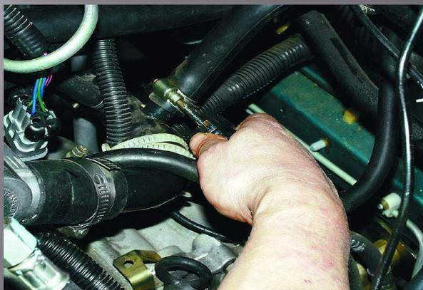
27. Разъедините колодку жгута форсунок, отжав пластмассовую защелку.
