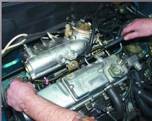
33. Вытащите жгуты проводов из-под термостата. После этого проверьте, все ли провода и шланги отсоединены от двигателя.
