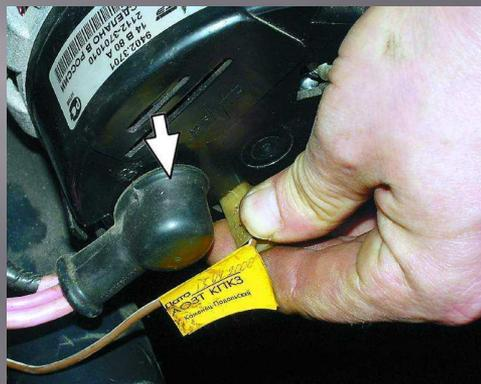
17. Отсоедините колодку с проводами от контактного болта (клеммы «В+») генератора. Пластмассовую защелку.
