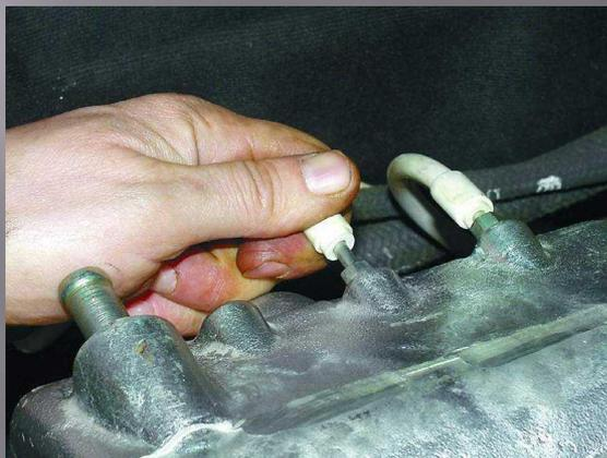
21. Отожмите пластмассовую защелку и отсоедините колодку с проводами от регулятора холостого хода, установленного на дроссельном патрубке.
