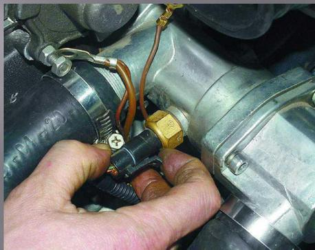
11. Ослабьте хомуты и отсоедините отводящий шланг радиатора от термостата и подводящий шланг радиатора от патрубка рубашки охлаждения.
