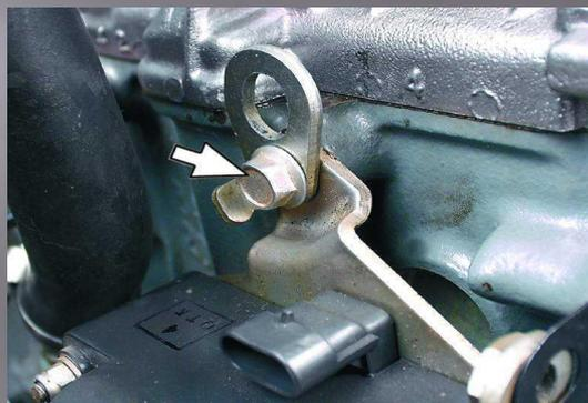
37. Вывесите двигатель, зацепив за два рыма трос и натянув его талью или краном.
