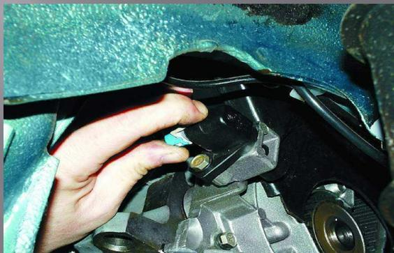
31. Отсоедините от передней крышки ремня привода распределительного вала два держателя с проводами, отвернув два болта крепления крышки.
