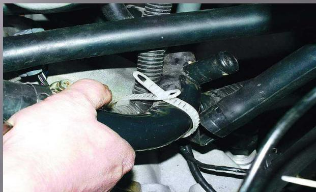
29. Снизу автомобиля отсоедините колодку с проводами от датчика 1 уровня масла в картере двигателя (рядом с масляным фильтром 2).
