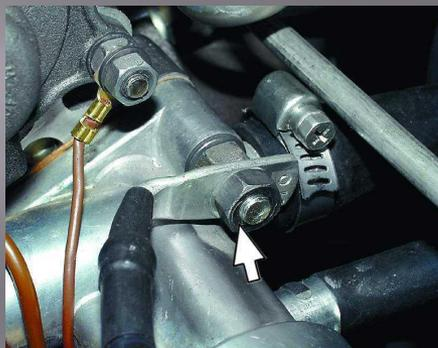
9. Со шпилек крепления задней крышки головки блока отверните две гайки крепления и снимите наконечники «массы»
