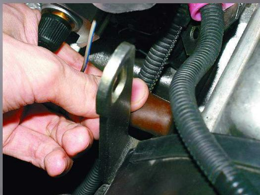
19. Отсоедините шланг вакуумного усилителя от штуцера ресивера, ослабив затяжку хомута.
