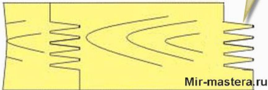
На рисунке приблизительно вид сращиваемых деталей после обработки фрезой. Не забывайте, что технология сращивания древесины предполагает тщательную сушку древесины.
