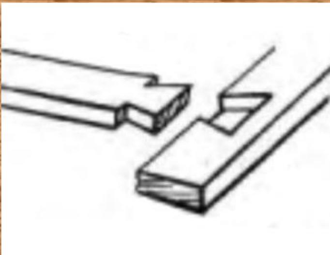
Соединение вполупотёмок означает, что шип просматривается только с одной стороны, обычно изнаночной, не видимой снаружи конструкции. Другая сторона смотрится вполне достойно, шипа не видно.
