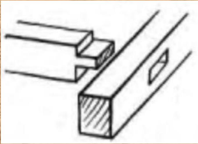
Помимо угловых соединений в столярном деле широко применяется ряд других соединений. Часто применяются т-образные соединения, когда требуется врезать одну деталь в середину другой. Соединение по внешнему виду схоже с буквой Т.
