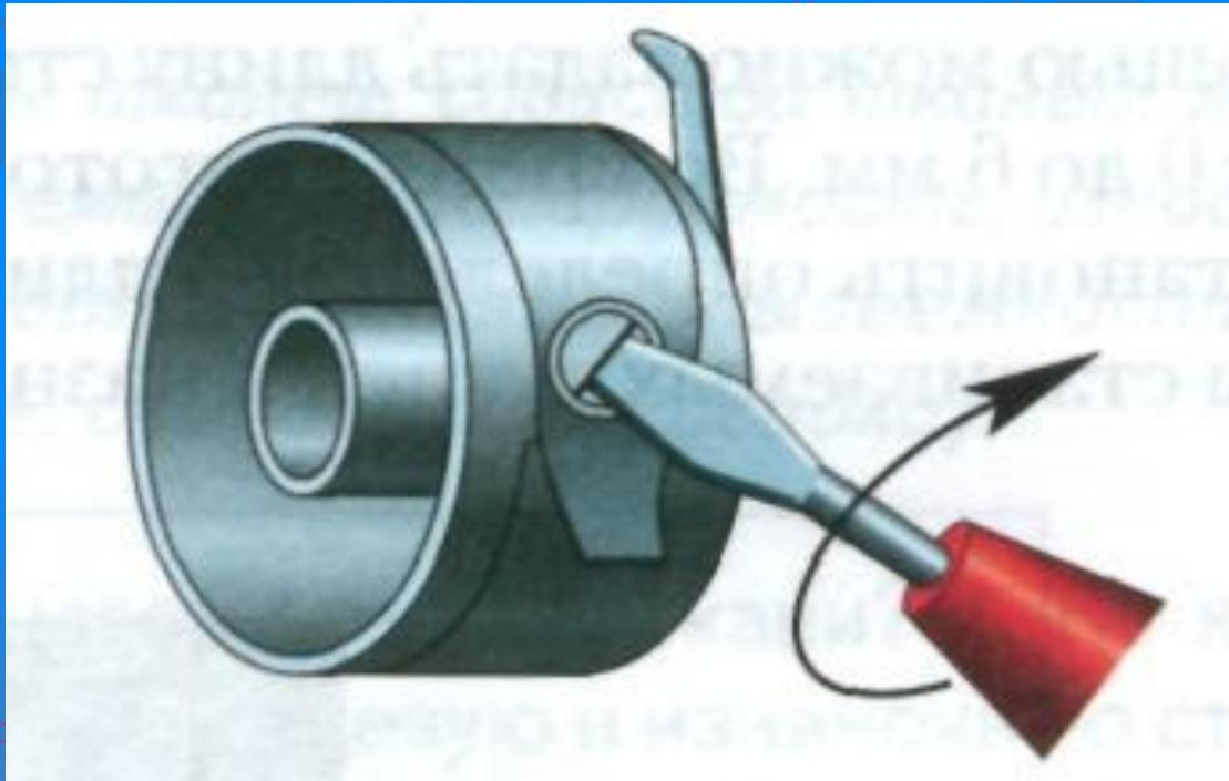
Неправильная регулировка натяжения верхней и нижней ниток приводит к дефектам машинной строчки.
