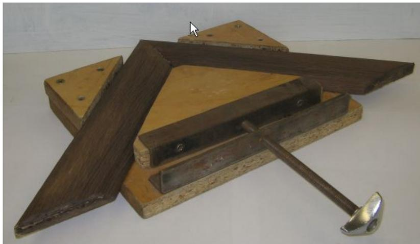
Приспособление для сборки рамок, запиленных «На Ус».
