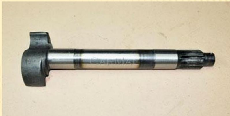
Восстанавливаемая поверхность шейки под втулки кронштейна. Износ рабочего профиля разжимного кулака восстанавливают наплавкой изношенной поверхности. Используют полуавтоматическую наплавку проволокой 51ХФА или пружинными проволоками ОВС, П1 в среде углекислого газа. Затем в автоматическом режиме наплавляют поверхности.
