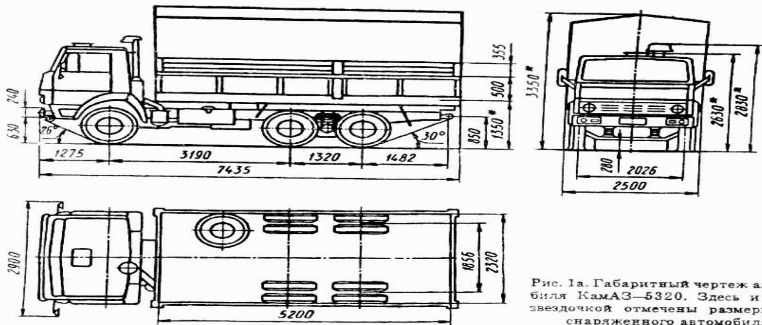
Рис. 1а. Габаритный чертеж автомобиля КамАЗ—5320. Здесь и далее звездочкой отмечены размеры для снаряженного автомобиля.
