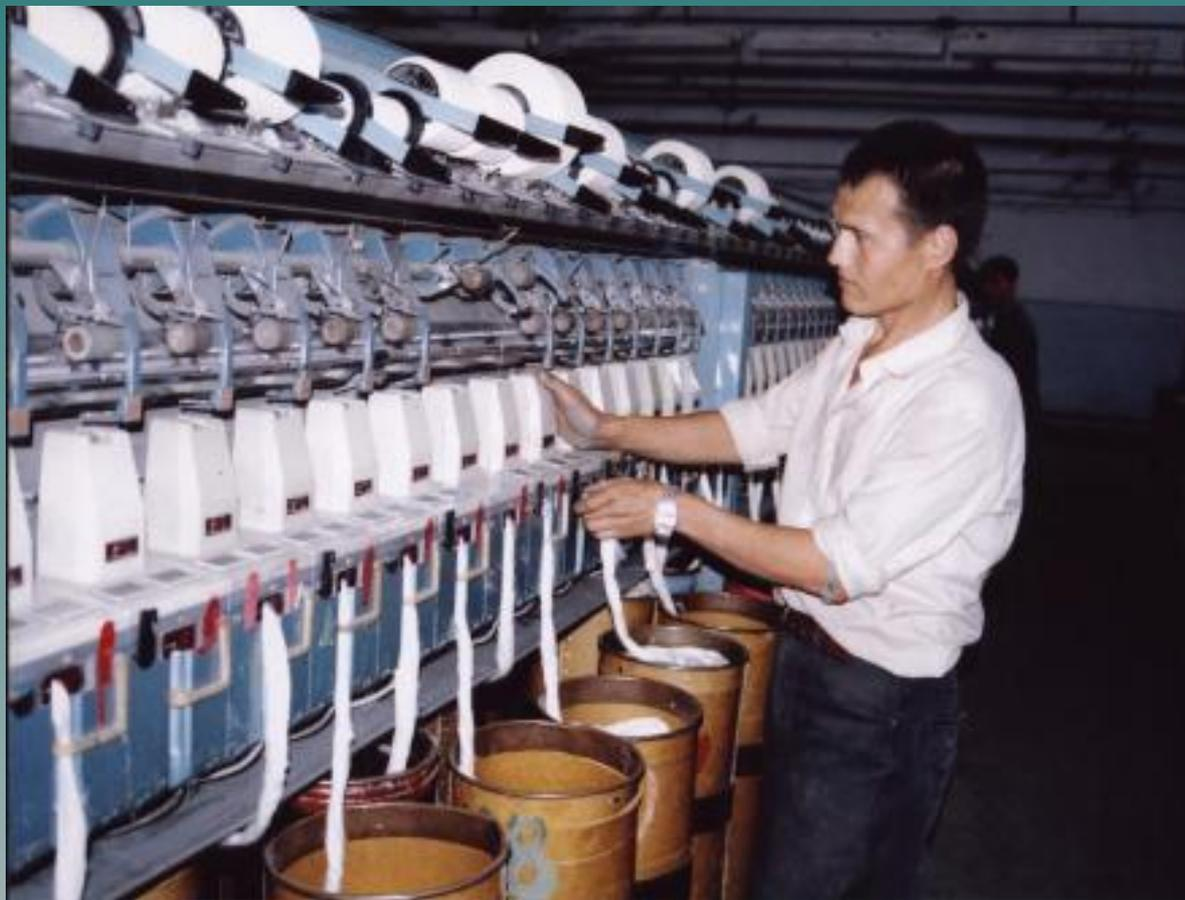
На прядильных машинах из ровницы получают пряжу, ровнице придают вытягивание и кручение с помощью веретен, которые вращаются со скоростью 8—14 тыс. оборотов в минуту. Каждая машина имеет около 200—500 веретен.
