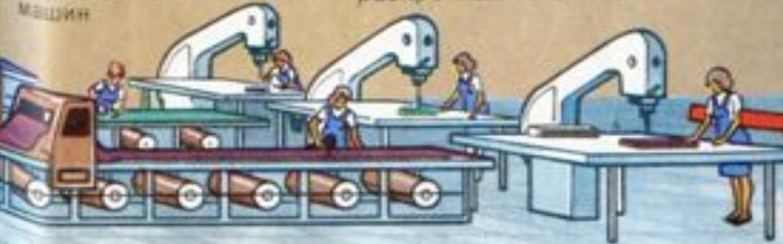
Окончательное вырезание деталей на ленточных раскройных машинах
