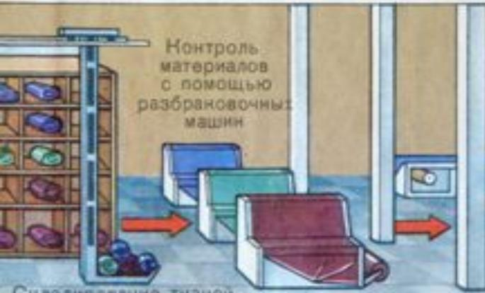
Настилание тканей с помощью настильных машин
