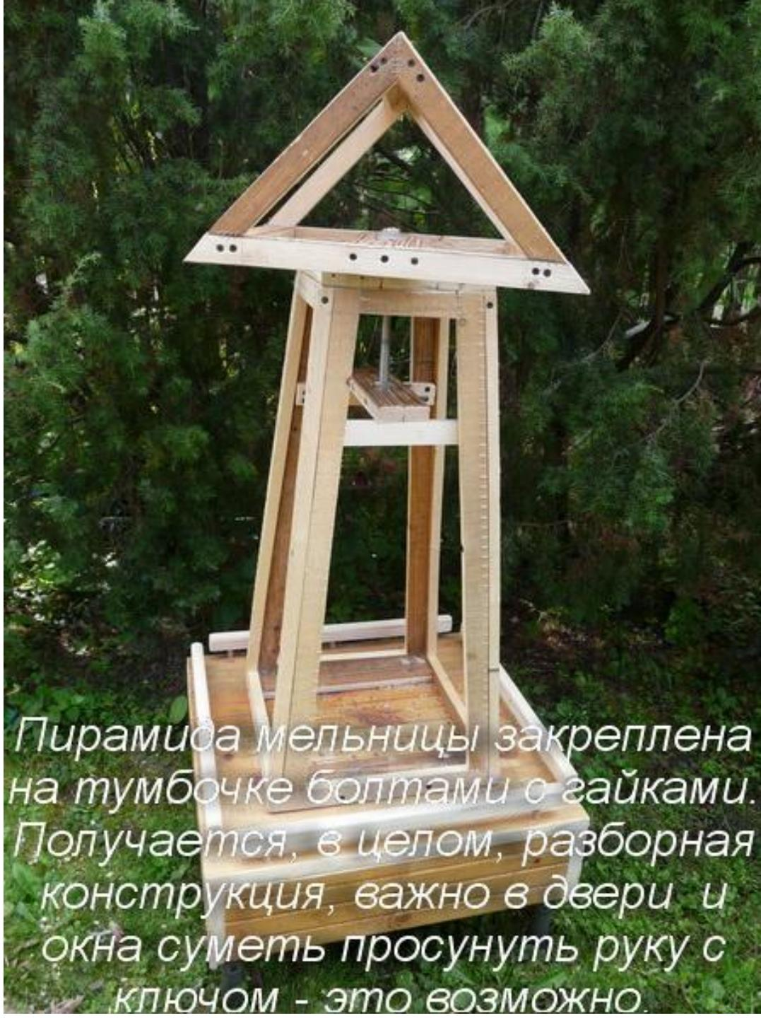
Пирамида мельницы закреплена на тумбочке болтами с гайками. Получается, в целом, разборная конструкция, важно в двери и окна суметь просунуть руку с ключом - это возможно.
