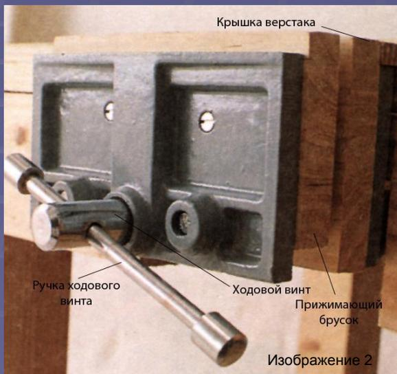
С его помощью вращением рукоятки ходового винта, которое вызывает перемещение прижимного бруска, можно закреплять или освобождать обрабатываемую деталь.
