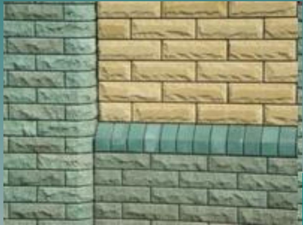
В зависимости от прочности на сжатие и изгиб плиты делятся на марки: 75; 100; 150. Водопоглощение плит из беложгущих глин – не более 12%, из остальных – 14%. Морозостойкость не менее 25 циклов. Плиты не должны иметь дефектов, искажающих лицевую поверхность.
