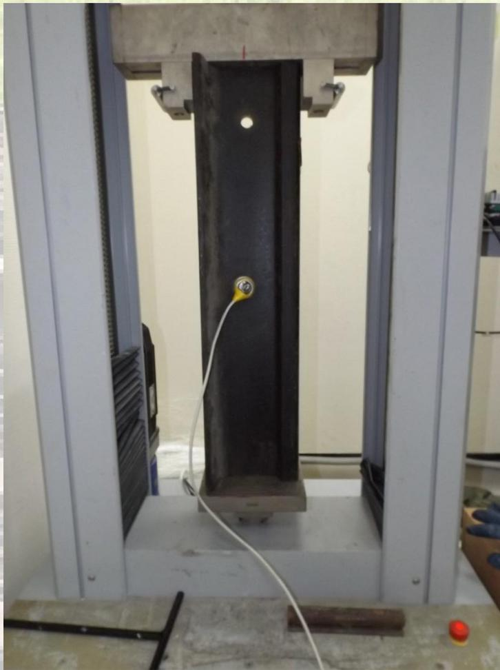
Датчики расположены в шейке рельса
