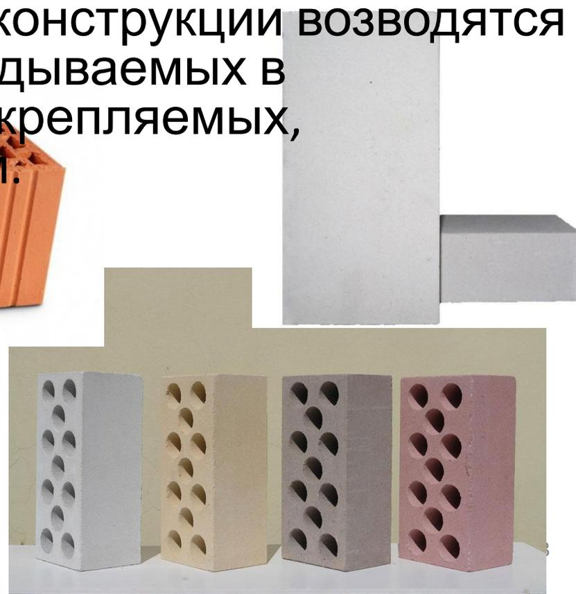
В настоящее время перспективными направлениями в развитии каменных работ является совершенствование каменных конструкций, облегчение их при сохранении необходимой несущей способности и теплоизоляционных свойств, что достигается использованием высокопрочного кирпича, армированием кладки, применением пустотелых керамических материалов и камней из ячеистых бетонов, внедрением облегченных кладок с эффективными плитными теплоизолирующими материалами
