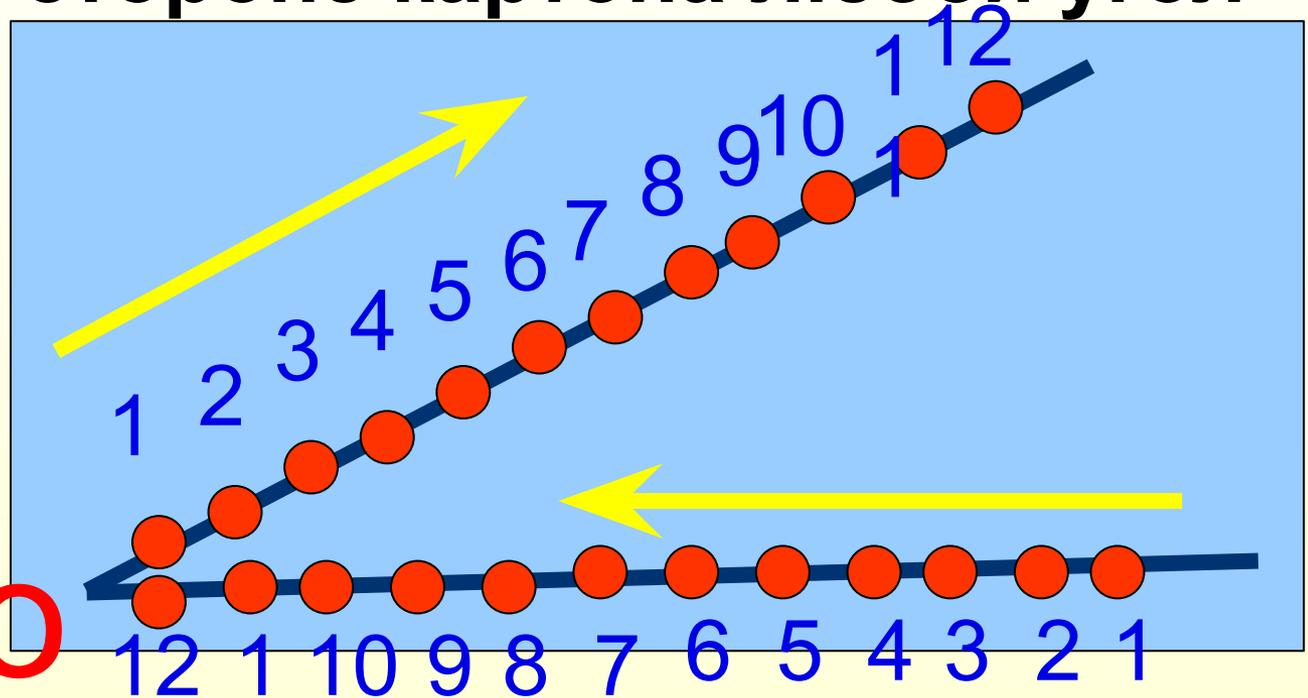
2. Разделите каждую сторону угла на 12<sub>1</sub> равных частей
