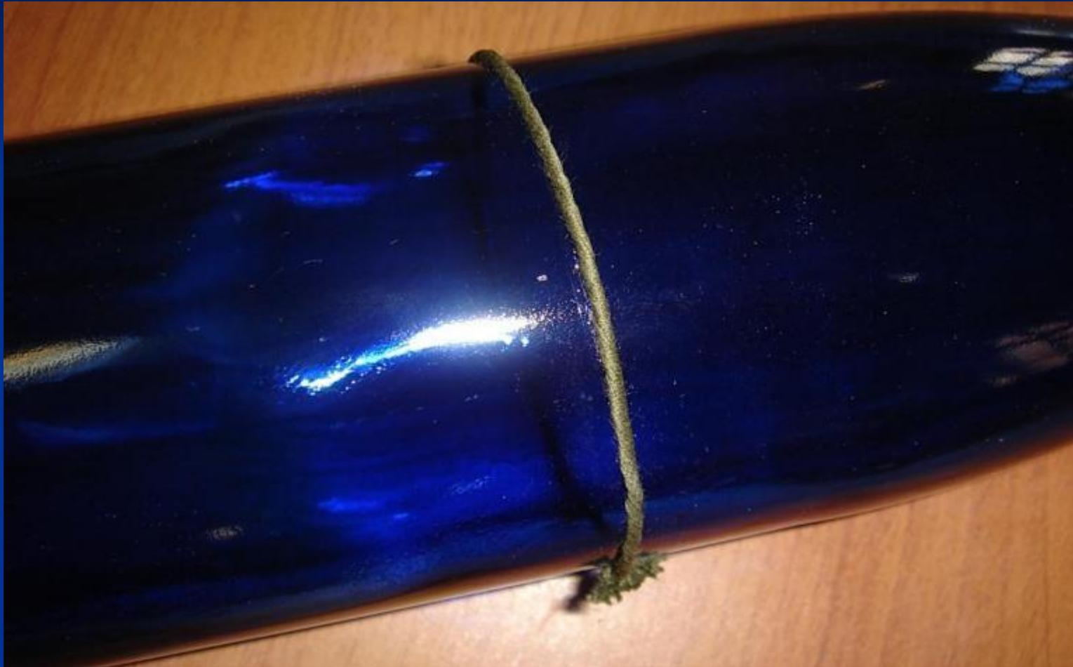
смачиваем нить горючей жидкостью и поджигаем ,
