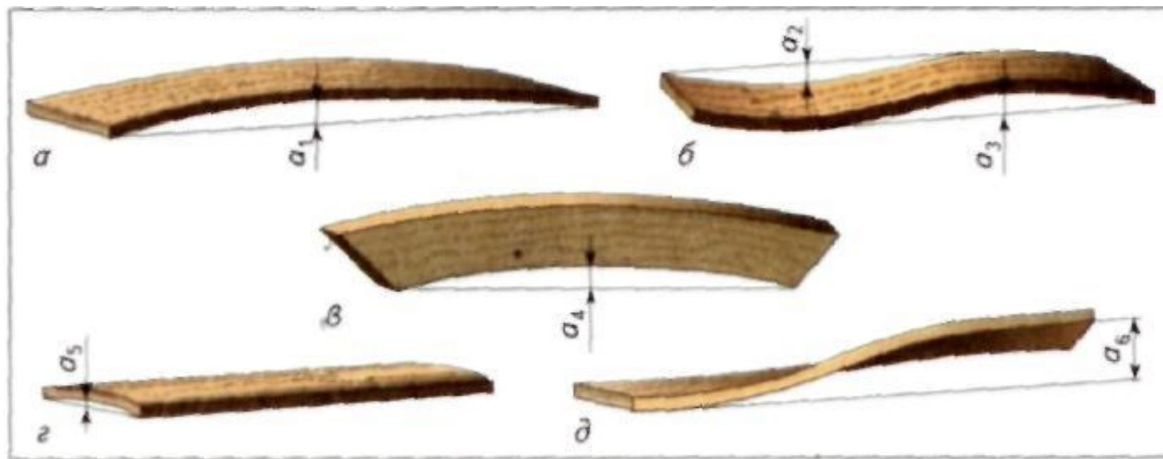
Рис. 3. Виды коробления досок: а, б, в — продольное; г — поперечное; д — винто-вое:  $\sigma_1$  —  $\sigma_6$  — величина коробления в мм
